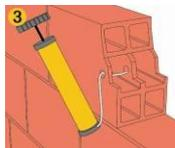
Отверстие должны быть очищены после каждого стадии очистки насосом или с помощью сжатого воздуха, начиная с нижней части отверстие (прокачка, по меньшей мере 1x).
