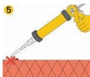
Прокачайте два раза, пока оба компонента не выйдут равномерно. Не использовать этот материал. Сбросить давление в пистолете и очистить отверстие картриджа тканью.
