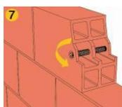
Закройте крышку перфорированной гильзы, чтобы избежать потерь смолы при внедрении стального стержня.
